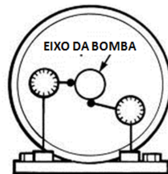
Figura 6.27: Movimento de tensão da tubulação
